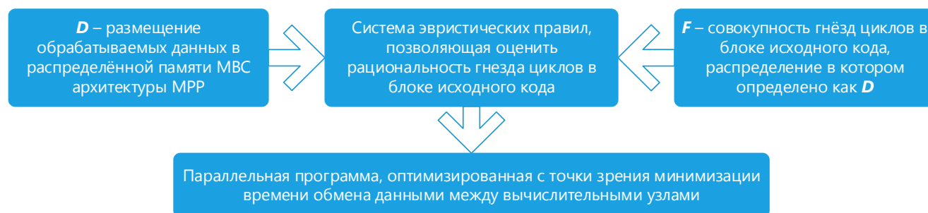
Рисунок 2 – Схема поиска рационального распределения данных в рамках блоков исходного кода на основе системы эвристических правил
