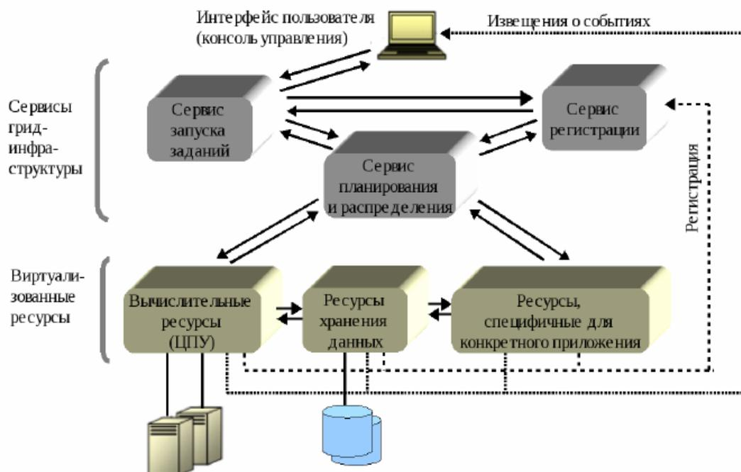
Рис. 14.3 упрощенная схема сервисно-ориентированного грида.
