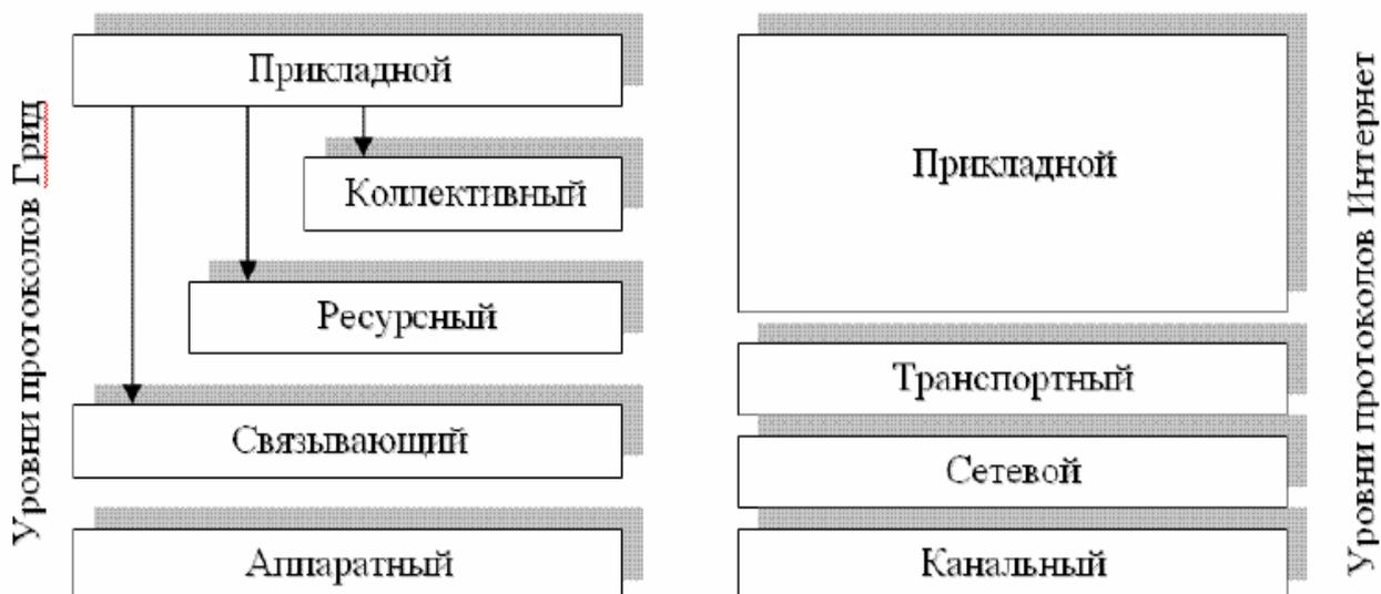
Рис.14.1 Стеки протоколов GRID системы и сетевой модели
